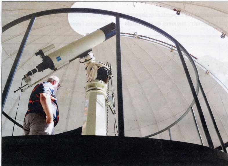
Telescopi Zeiss de l'Observatori de l'Ebre, l'aparell que fa fotografies diàries al Sol. / ACN
