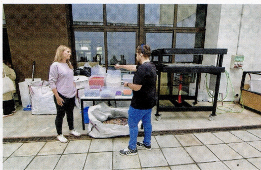
La màquina fon tps de plàstic triturats, procedents habitualment d'ampolles. FOTO: JOAN REVILLAS
