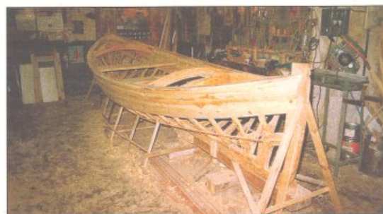
La muleta 'Dànae' en la fase d'enllestir la boca, o sigui en el moment d'haver subjectat les quadernes, bancs i cobertes i els elements que conformen l'obra morta.
