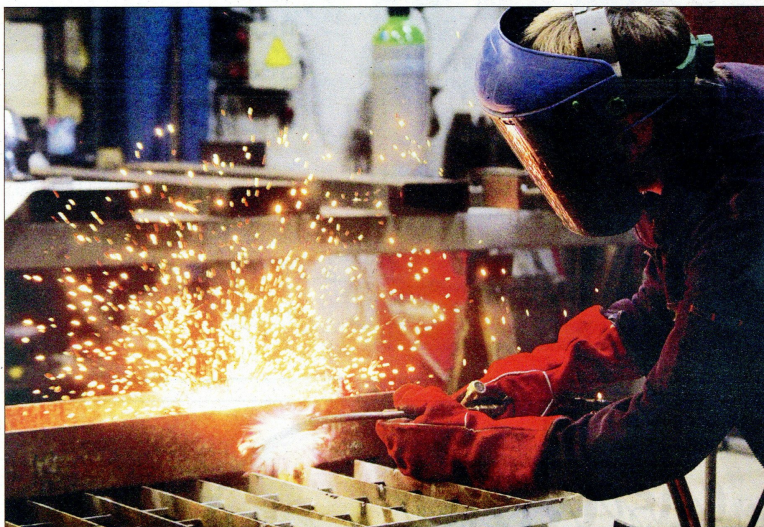
Al l'esquerra, un dels treballadors de TMC realitzant una demostració de la pràctica oxitall. A la dreta, una de les grues de l'empresa Romaní com la que es farà servir per a treure el monument. NÚRIA CARO
