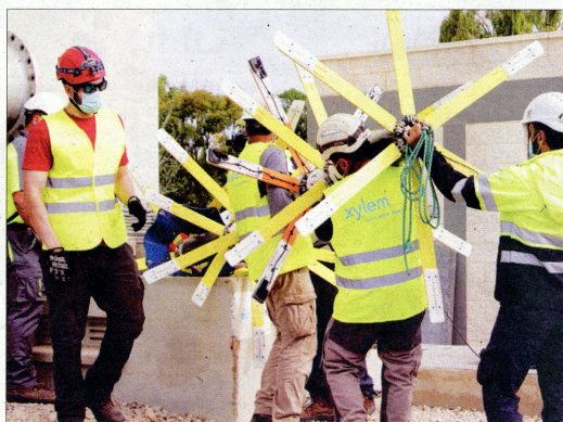
A l'esquerra, imatge de la canonada del CAT que va rebentar el passat 3 de gener a l'Ampolla. A la dreta, el torpede Pipe Diver que s'ha inserit per a inspeccionar l'estat de la xarxa principal del CAT des de Campredó fins a Constantí. / CEDIDA I NÚRIA CARO
