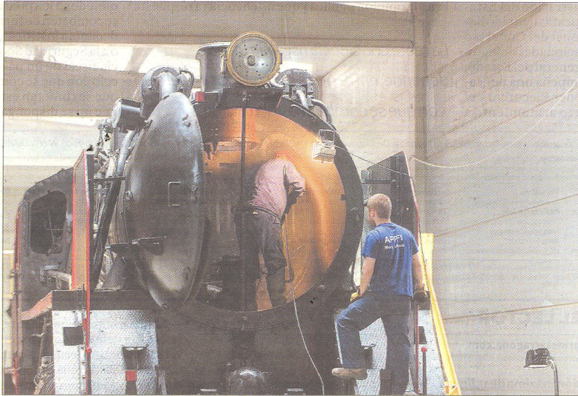
Els voluntaris de l'associació netegen i desmunten els tubs de la caixa de fums de la màquina. FOTO: JOAN REVILLAS
