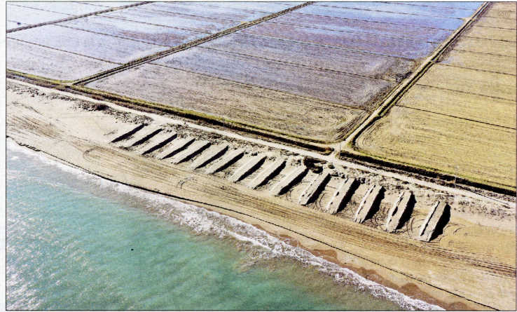
Imatge aèria dels monticles d'arena afegits a la Marquesa abans del temporal Isaak. FOTO: MITECO
