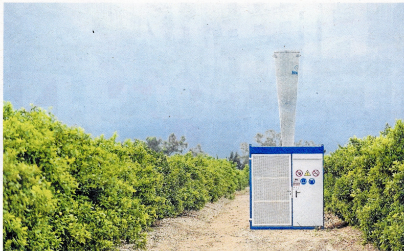
Un dels canons antipetra, a la finca de cítrics. FOTO: JOAN REVILLAS
