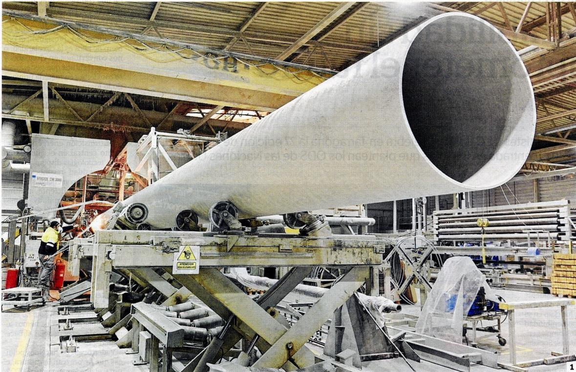
1. La fábrica de Amiblu en Camarles es la más importante del grupo en la tecnología de fabricación de tuberías con filamento continuo.
